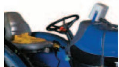
Tenga en cuenta, la caja de control y el aspersora ESS es un sistema de 12 voltios. El uso de un sistema de 24 voltios puede dañar la electrónica.
