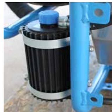
*Depósito de aceite del supercargador*
